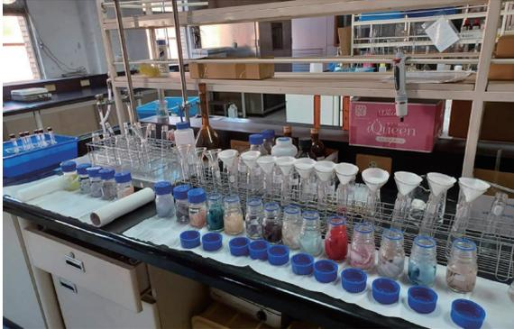
圖11 甲醛試驗樣品過濾製備中
