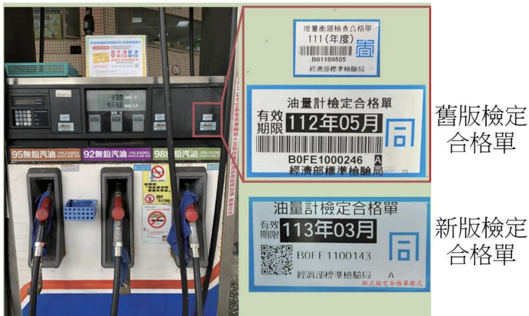
圖2 加油機之油量計檢定合格單及度量衡器檢查合格單
