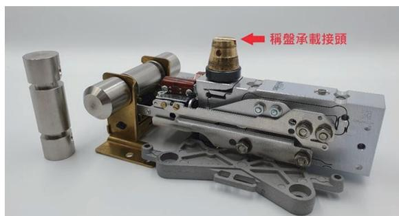
圖2 天平荷重元與內藏法碼相關位置，左側直立圓柱體為拆下的內藏法碼
