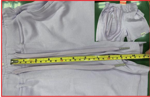
圖6 不合格範例：拉繩長度大於7.5 cm且無固定端，拉繩可逕直被拉出。
