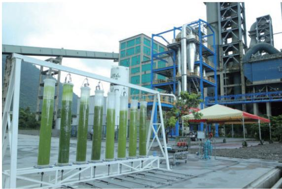
圖9 微藻養殖之光生物反應器[16]
