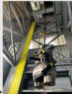
(二)將軀幹試驗塊以直立之姿態拉高，以快速釋放裝置將其支撐於定位，將試驗繫索之一端以符合CNS14253-5規定之連接器，接於供試驗用之擒墜裝接元件，並以相同方式，將另一端接於試驗台錨定座。
