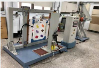
▲搖晃推拉試驗機及側邊往復衝擊試驗機設備圖
