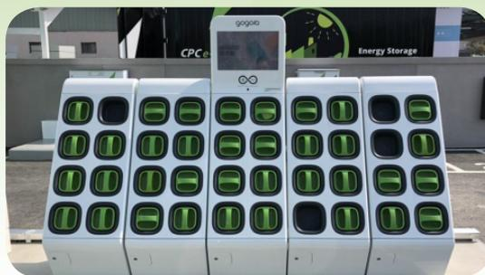
▲ 應施檢驗商品 - 電動機車用電池交換系統設備
