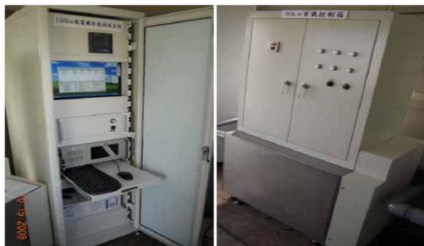
圖 1 150kW 以下戶外風力機性能驗證系統
