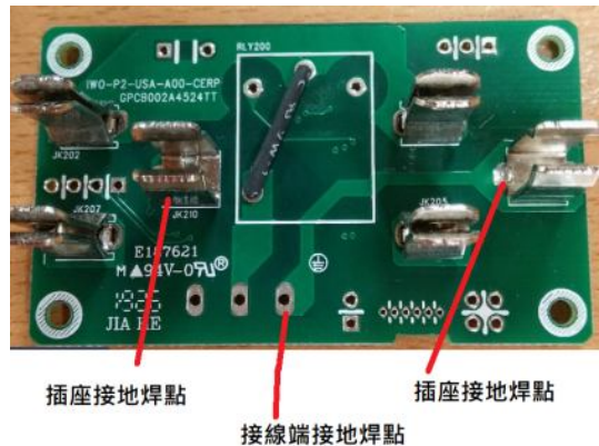
正面接地電路迴路圖 (圖 5)
