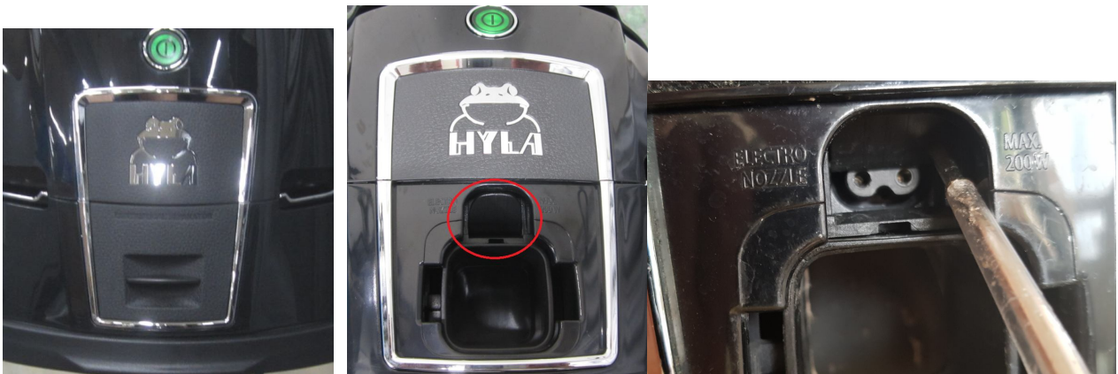
產品本體吸入口及電器用耦合器結構
