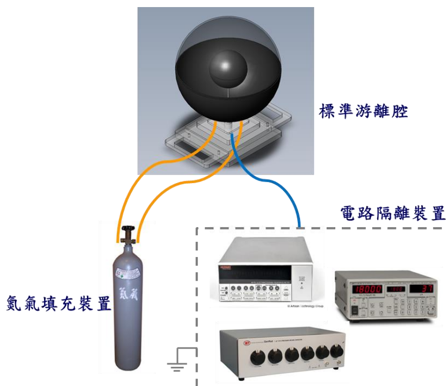
圖 18、環境級劑量量測系統設計
