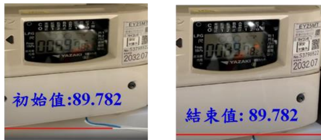
圖 4-7、超音波氣量計流動方向測試
