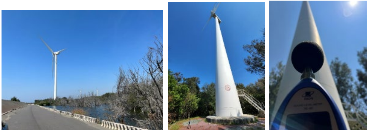
圖 1-2-17、四湖風力發電站(左)、風機葉片檢測中(中)與量測儀器_積分噪音計(右)
