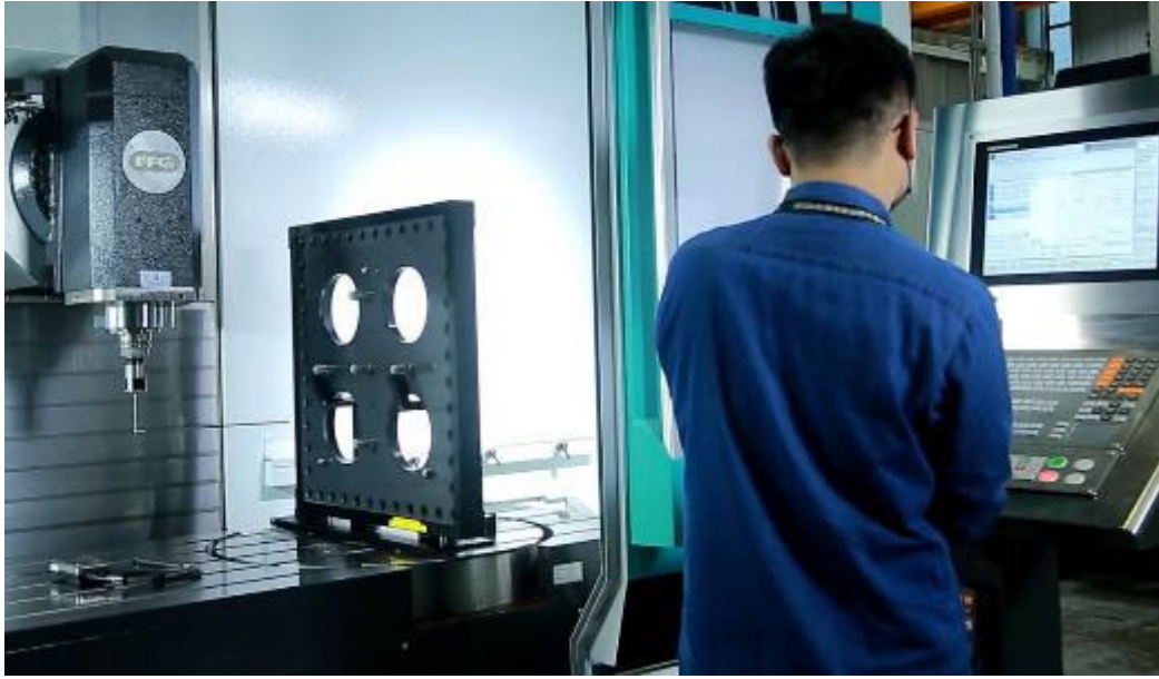
圖 2-3-9、實機測試，進行五軸工具機量測
