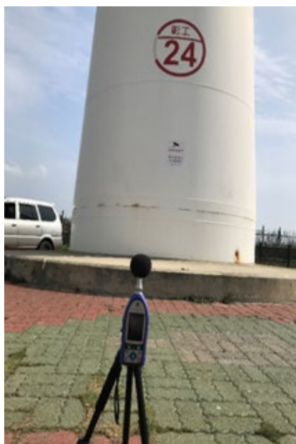
圖 4-1-9、風力發電機葉片運轉聲音檢測
