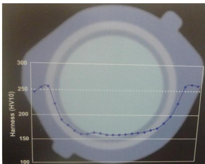
2. 電阻銲鋼管之銲道金屬流線檢測，近年來已成為除金屬化學成分與機械性質檢測外之鋼管成形重要檢測項目，其目的在於檢測鋼管銲接時，銲道金屬受擠壓之流動方向，用以判定該銲道品質之優劣及銲接製程參數之適用性。
