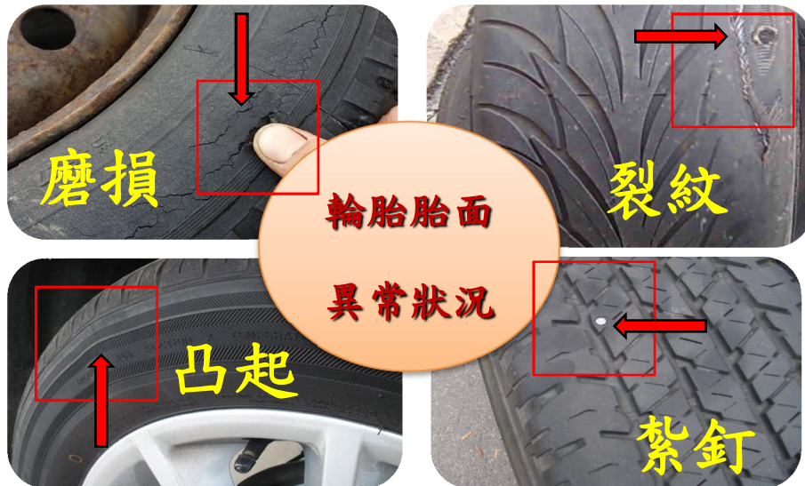
圖 5 輪胎胎面異常狀況(不規則磨損、裂紋、凸起、紮釘)
