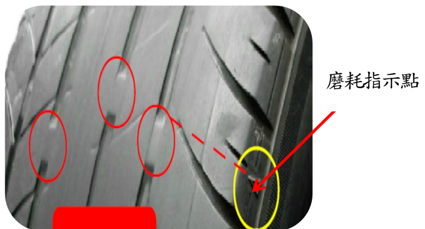
圖 4 輪胎溝紋已磨耗至指示平臺(須更換新胎)
