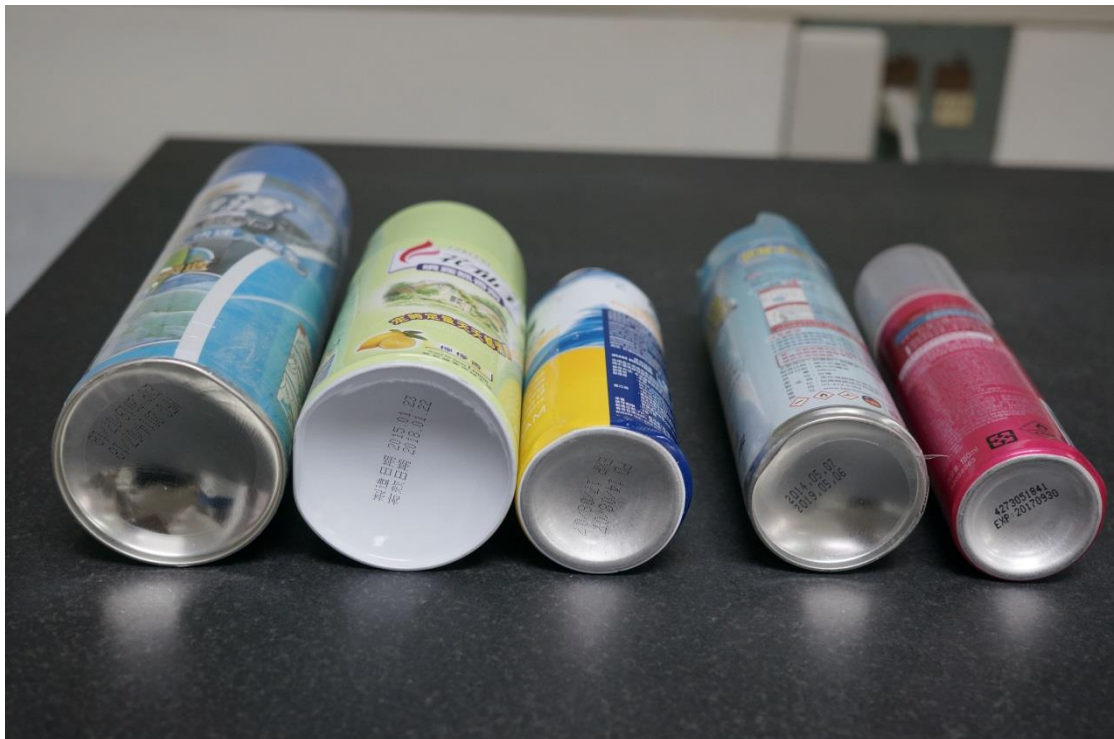
圖 20 落下試驗噴霧罐變形
