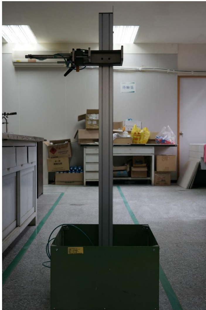
圖 17 落下試驗設備
