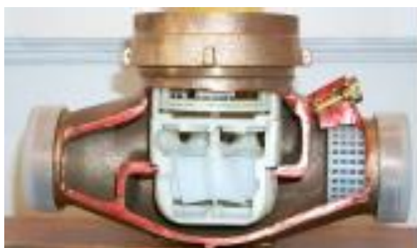
圖 1 水量計切割圖(來自參考資料 8)
