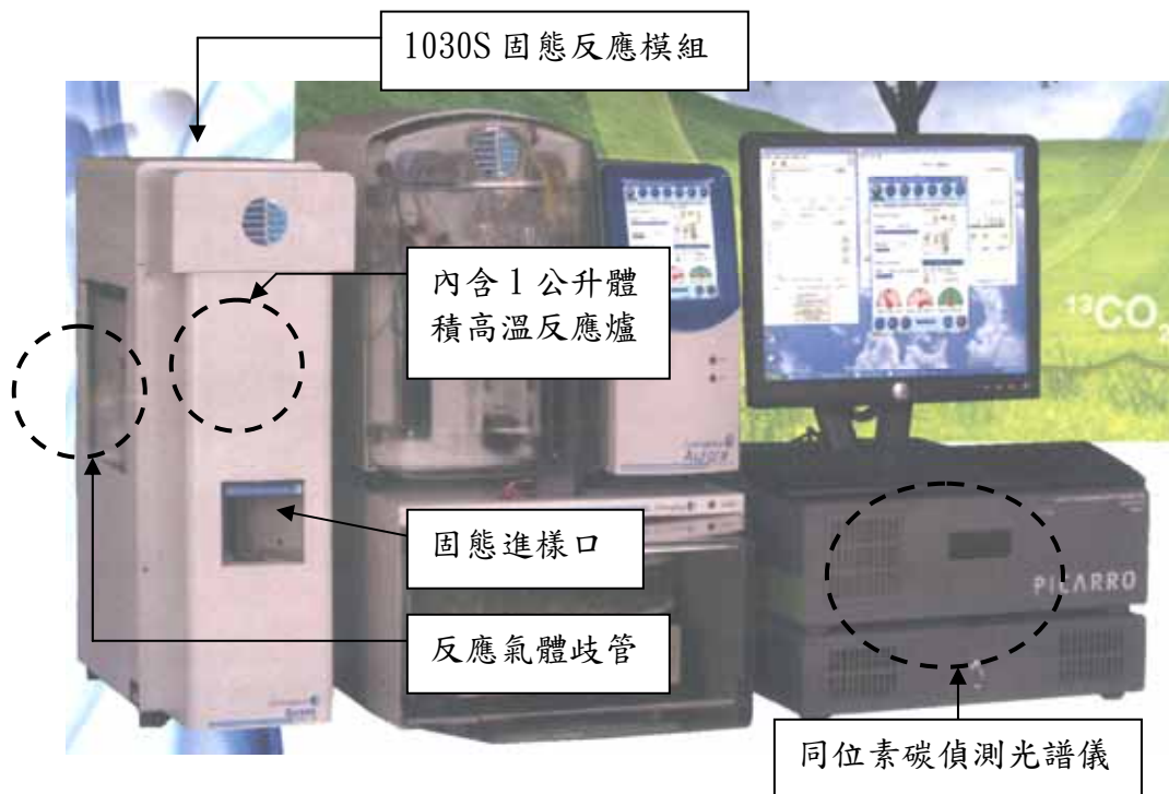
圖 2. 1030S 固態反應模組暨同位素碳偵測光譜儀說明圖示
