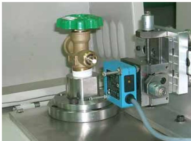
鋼瓶閥之安全閥排放能力測試設備
