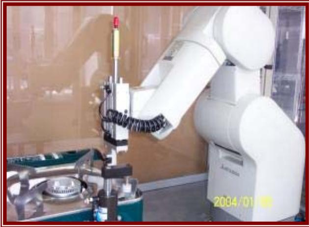
圖一 五軸機械手臂
