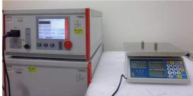
圖 4-1-2、B.3.1 交流電源電壓瞬降和短時中斷測試 EUT 配置
