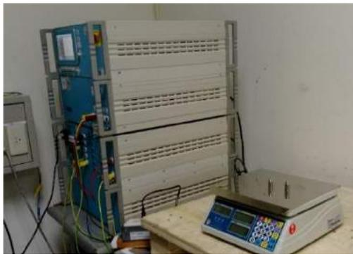
圖 4-1-6、突波測試項目之架設配置圖
