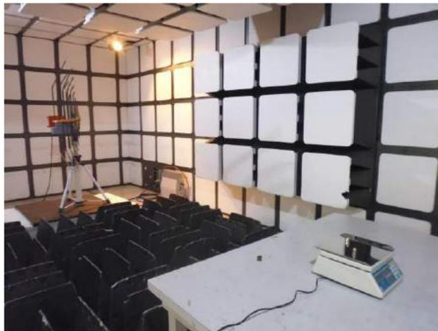
圖 4-1-12、電磁耐受性測試項目之架設配置圖
