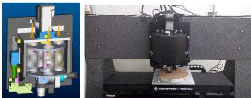
圖 2-2-3、白光干涉模組設計機構圖面與實體裝置圖
