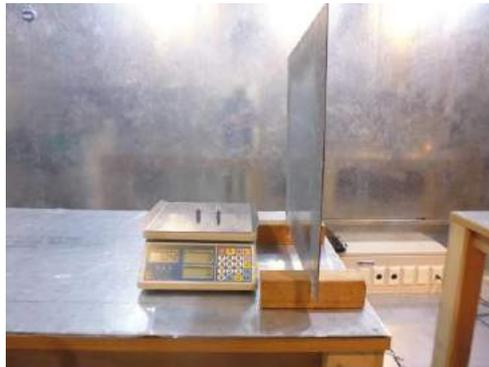
圖 4-1-9、靜電試驗(間接放電)與 EUT 配置圖
