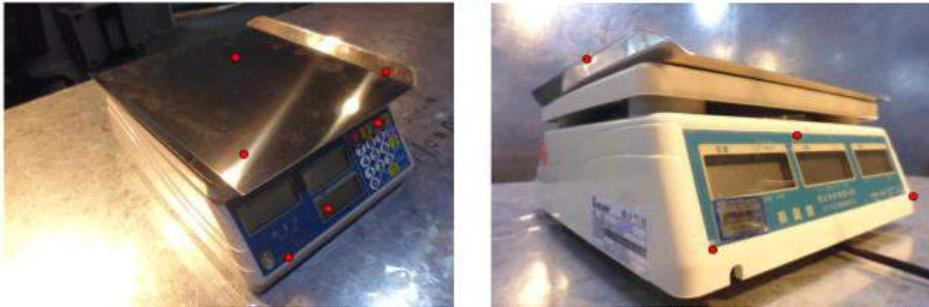
圖 4-1-8、靜電試驗(直接放電：接觸放電/空氣放電)與 EUT 配置圖
