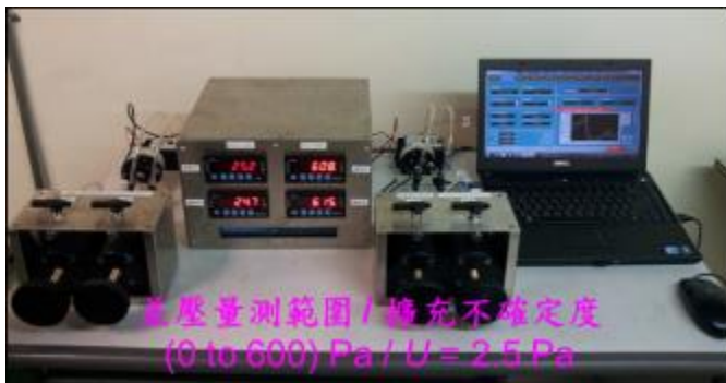
圖 2-1-9、自行開發之活塞式壓力校正系統
