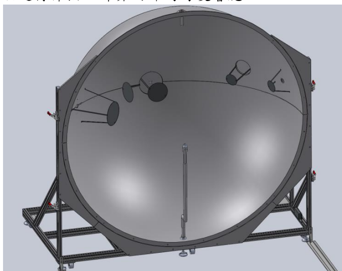
圖 1-3-29、3 m 積分球量測系統內部開孔設計示意圖
