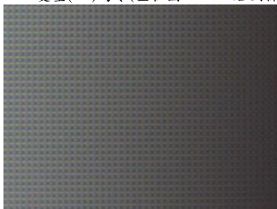
圖 3-2-17、光學顯微鏡觀測 3 \mu\text{m} 之二維線距標準片影像
