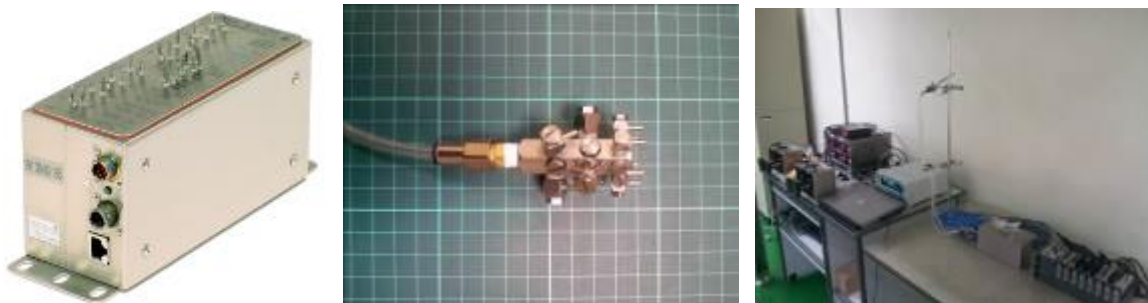
圖 2-1-8、壓力掃描模組(左)、壓力校正接頭(中)、連接方式(右)
