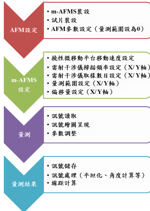
圖 1-3-5、計量型 AFM 操作流程
