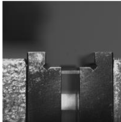
圖 2-2-14、以夾治具固定待測物
