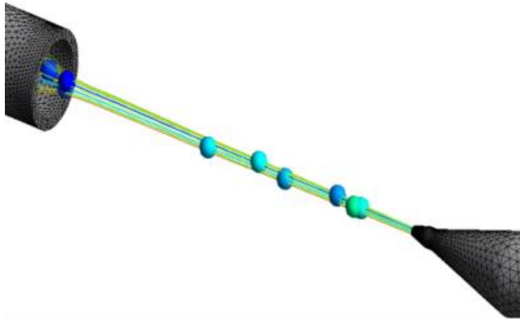
圖 3-1-19、高效率氣膠噴嘴之 200 nm 微奈米顆粒運動軌跡模擬圖
