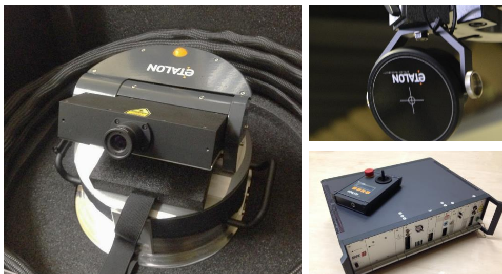
圖 2-2-1、LaserTRACER 本體及其貓眼反射鏡、控制機箱
