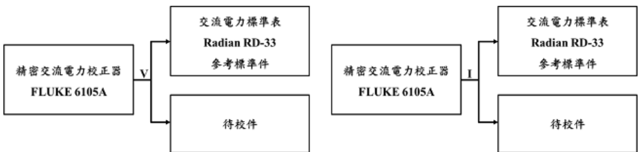
圖 2-3-2、電壓/電流諧波校正接線圖
