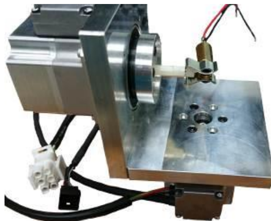
圖 2-2-8、追蹤信號與性能測試用雙軸旋轉機構
