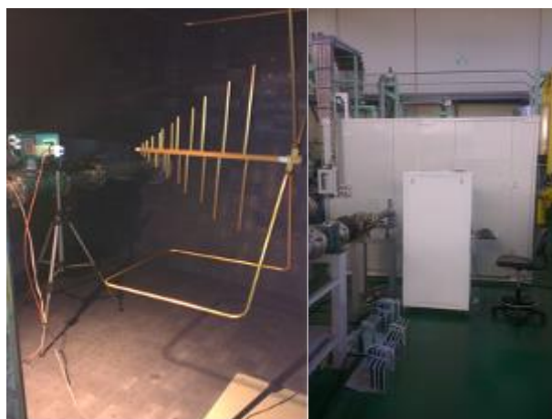
圖 4-1-9、隔離箱內外的水量計架設情形
