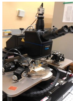
圖 3-2-5、量測電阻率之儀器設備
