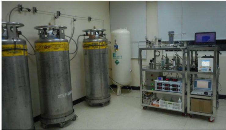
圖十七：微量水氣產生暨量測裝置硬體設備
