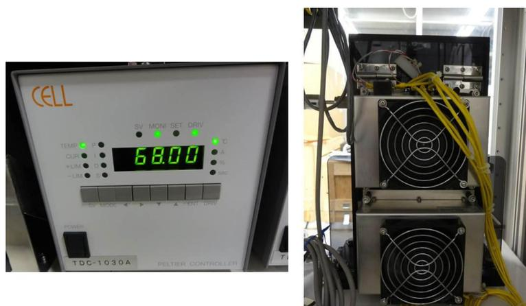
附圖 7：微量水氣產生腔體-溫度控制於 68 °C
