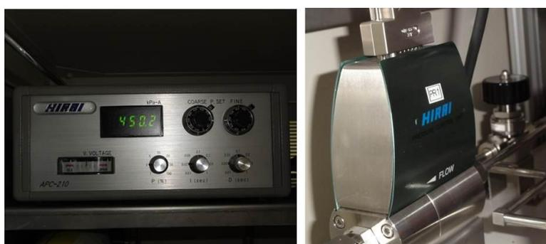
附圖 8：微量水氣產生腔體-壓力控制於 450 仟帕
