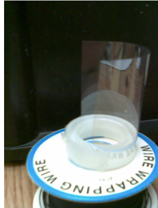
圖- 27：撓曲半徑為(a) 27 mm、(b) 22 mm、與(c) 19 mm 的樣品實體(右)，以及實際將樣品置於 THz 量測架構中(左)的照片
