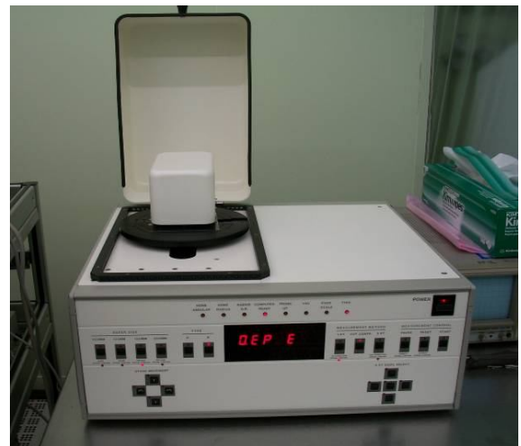
圖-16：可撓導電基板之曲面下四點探針片電阻量測架構示意圖與實體
