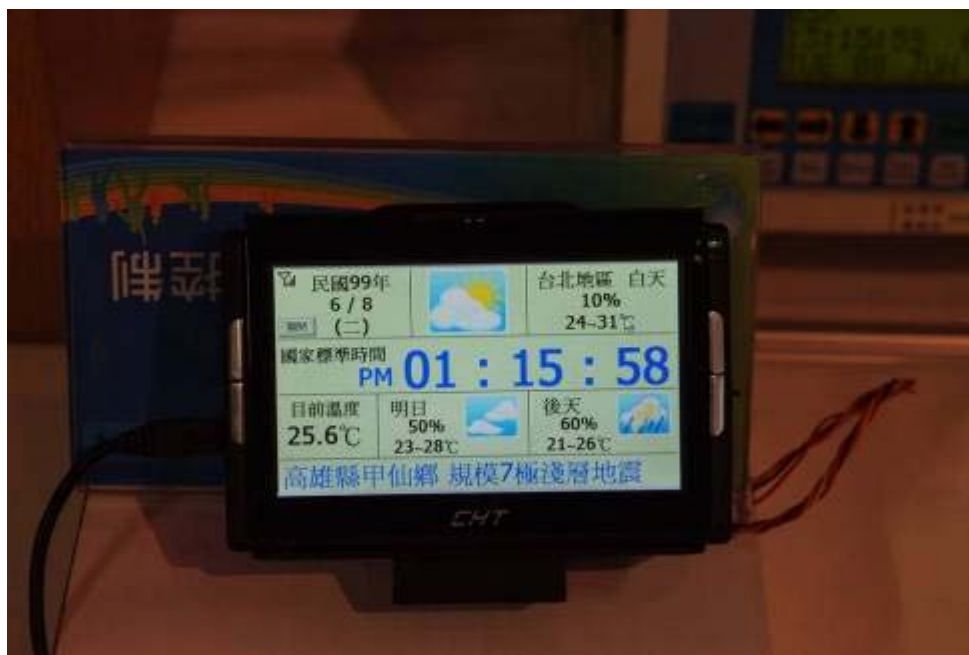
圖 2.5- 3： 車機整合低頻接收機模組而成之低頻智慧多功能電波鐘
