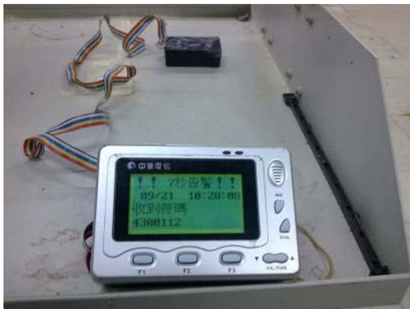
圖 2.7-13：實驗電波鐘於 10:28:08 接收到 7 秒的緊急告警碼框
