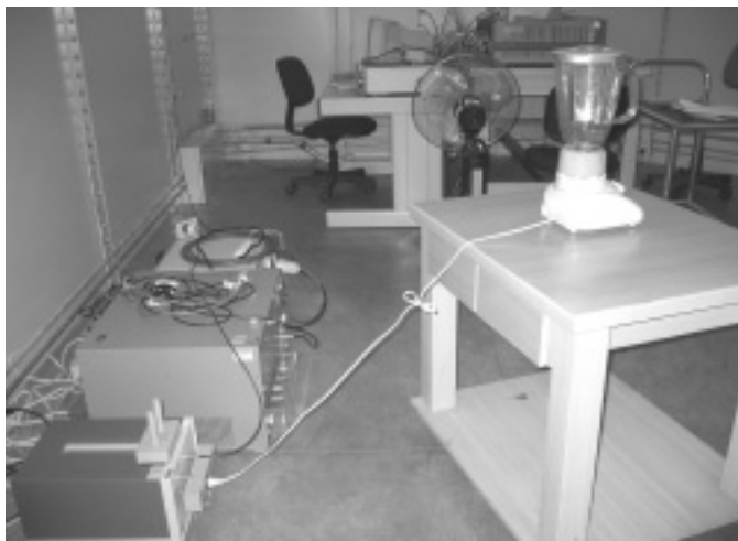
圖 10 家用果汁機電壓傳導干擾測試
