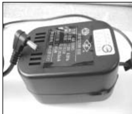
圖 5 線性式整流器外觀(3V) (具經濟部標準檢驗局合格標識)
