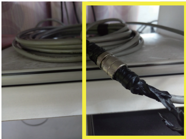
▲傳輸線截斷接上作弊元件轉接頭
