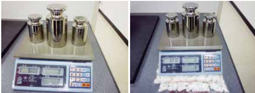
▲磅秤下面有無墊泡棉之比較圖：電子秤於正常桌面上是9000公克（左）；電子秤放置於有泡綿軟墊上是8970公克（右）（三顆標準法碼共重9000公克）
