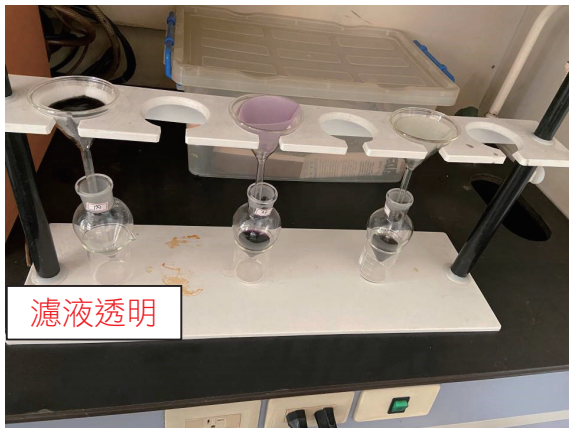
圖3 以沸騰二甲苯萃取後經趁熱過濾情形圖
