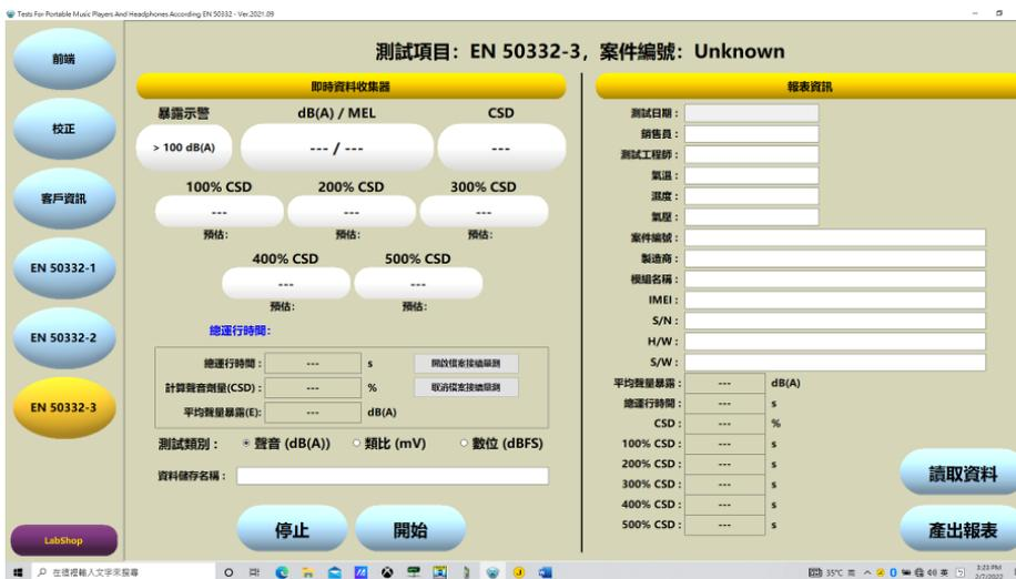
圖 9 EN 50332-3(同 CNS 15027-3) 聲音顯露劑量測試
