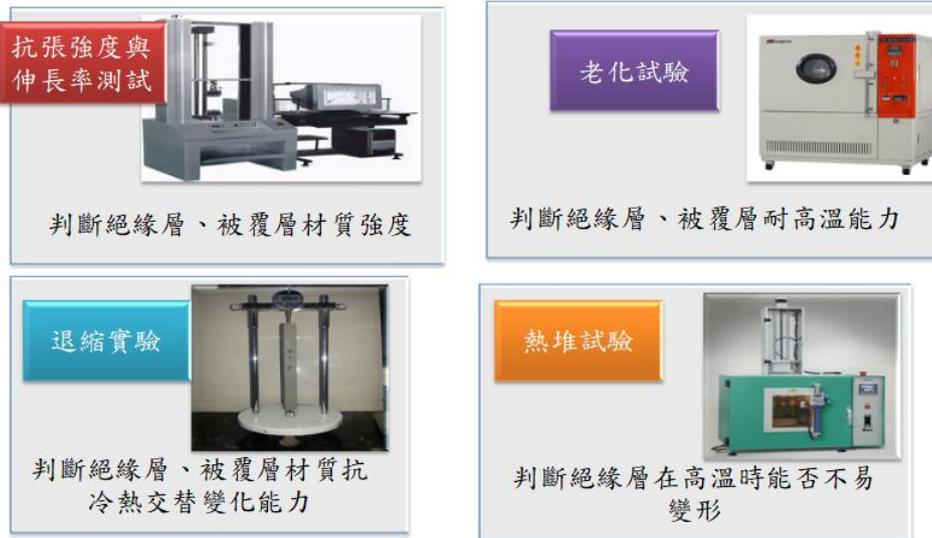
圖18 非電氣測試主要試驗項目
