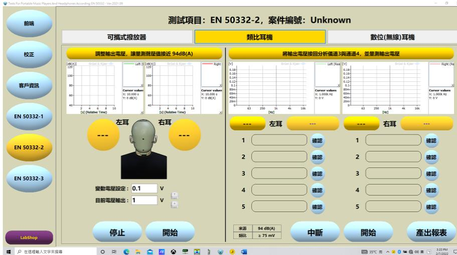
圖 7 EN 50332-2(同 CNS 15027-2) 類比耳機測試
