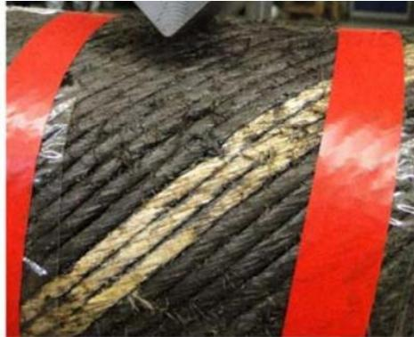
圖8 海底電纜聚丙烯(polypropylene, PP)線層
