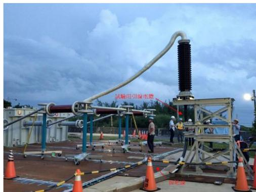
圖19 台澎海底電纜交流耐壓試驗
