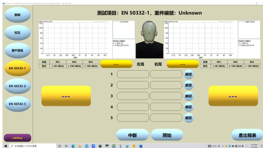
圖 5 EN50332-1(同 CNS 15027-1) 聲壓測試
