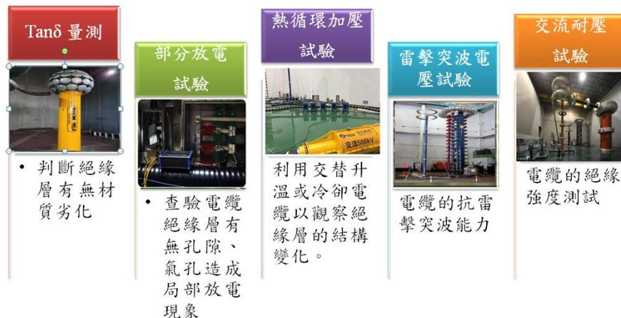
圖17 電氣試驗主要試驗項目
