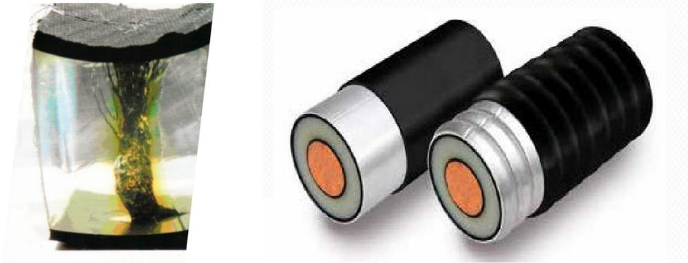
圖4(左)海底電纜經海水滲透後在絕緣體間產生的水樹結構；(右)絕緣層外鉛被結構
