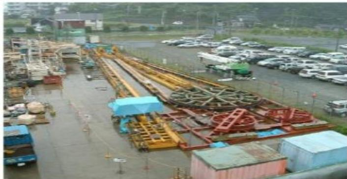
圖7 日本住友電氣工業株式會社之海底電纜張力彎曲試驗
