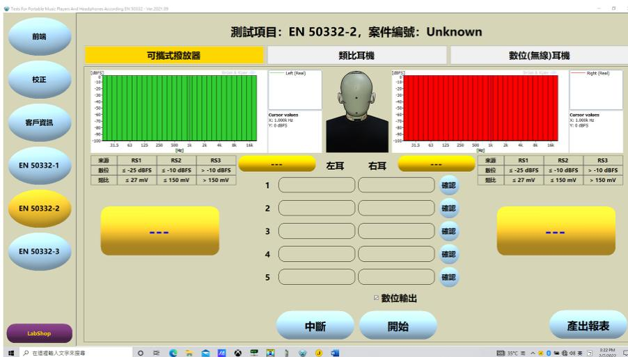
圖 6 EN 50332-2(同 CNS 15027-2) 可攜式播放器測試
