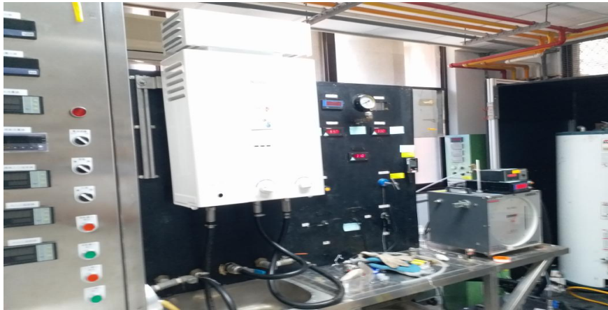
燃氣消耗量試驗設備
