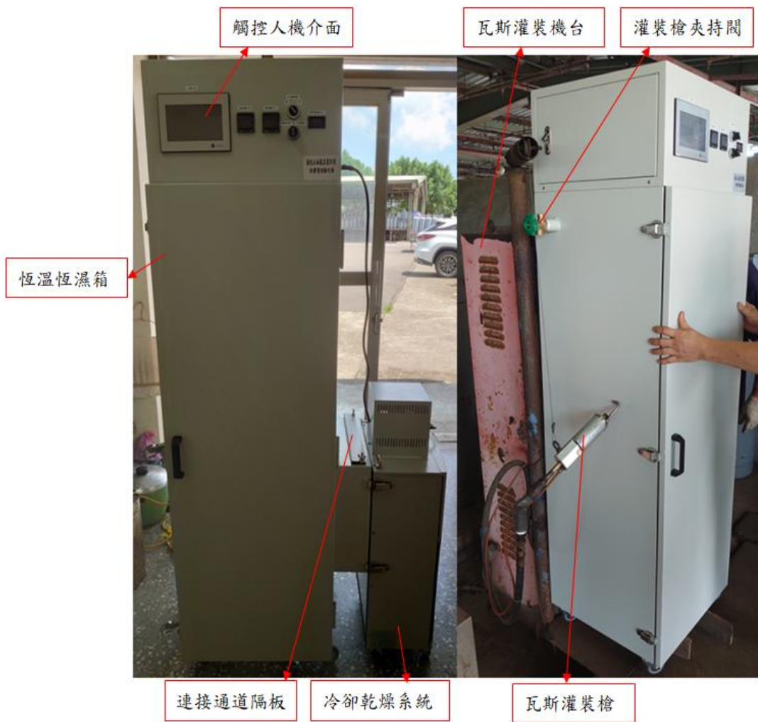
圖3a 設備外部照片
