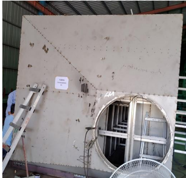
圖參-13、活性炭吸附塔廠驗現場圖
