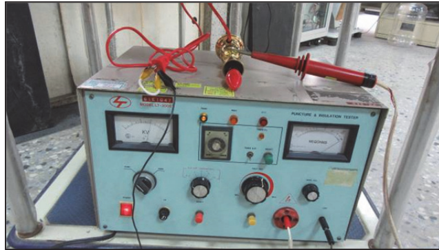
圖 4 神明燈的絕緣耐電壓測試
