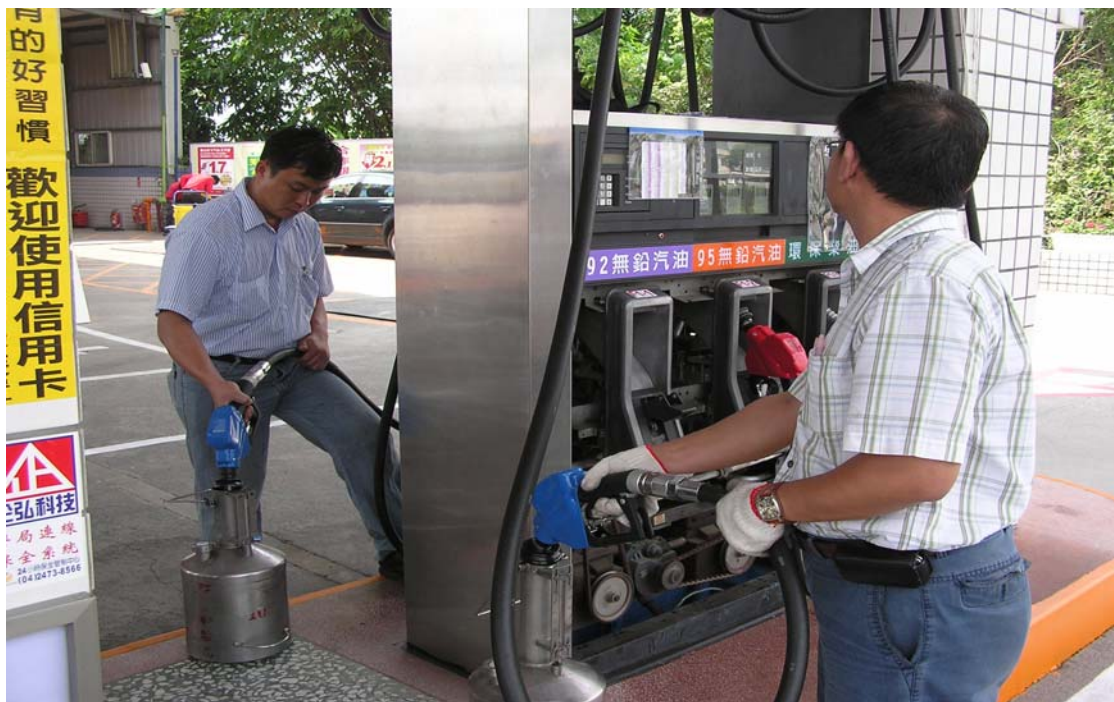
圖 10 內、外側二 92 油槍同時檢定
