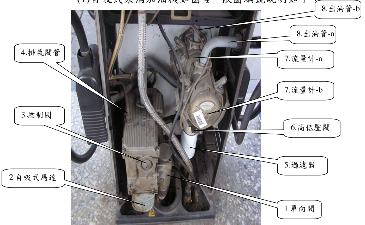
圖 4 自吸式泵浦加油機構造(廠牌 NUOVO-PIGN，型號：DP-090-GE)
