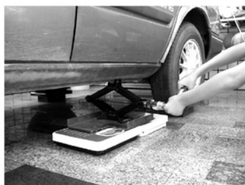
圖14 以扭力計操作量測千斤頂
