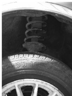
圖12 左前輪獨立式懸吊彈簧
