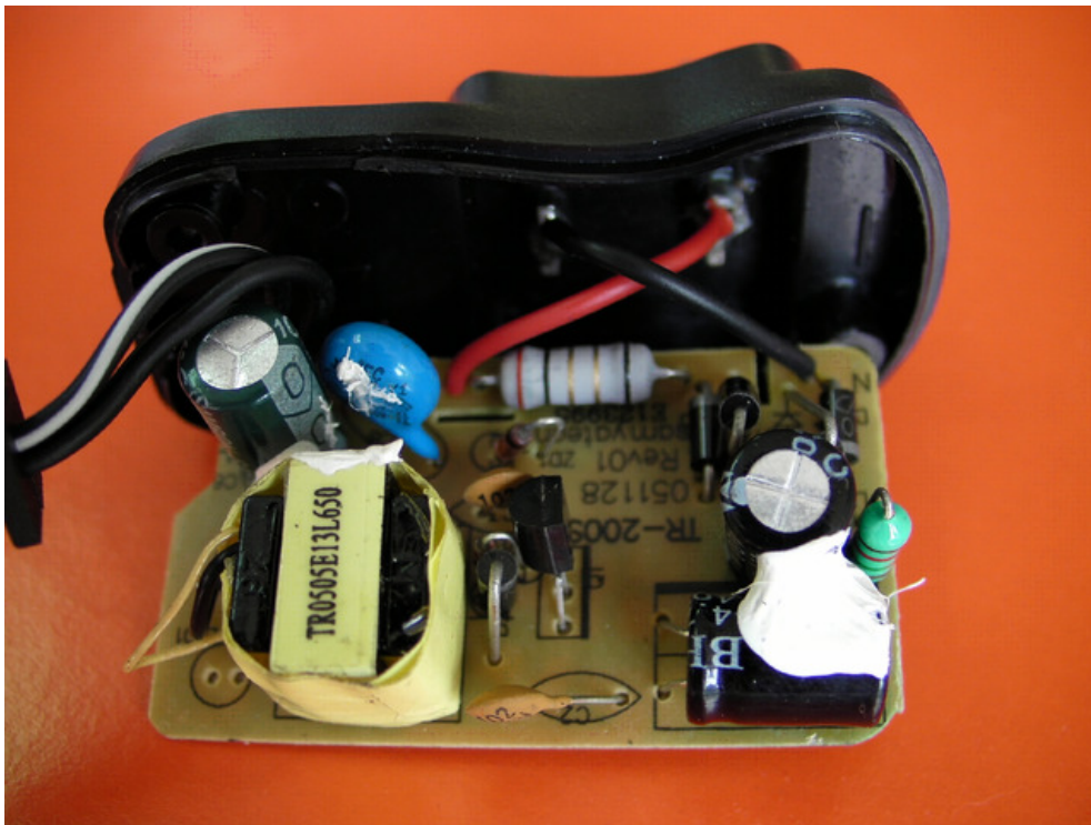
圖 4-52. 8 號樣品變壓器內部電路上方
