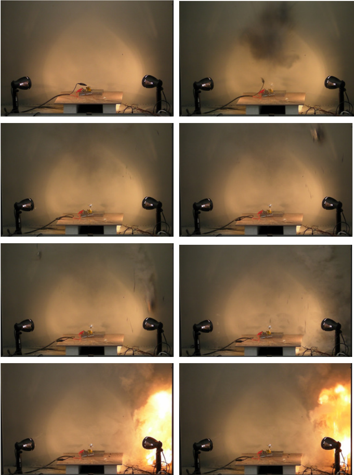
圖 3-12. 鋰二次電池爆炸過程(全景攝影每秒 60 張)
