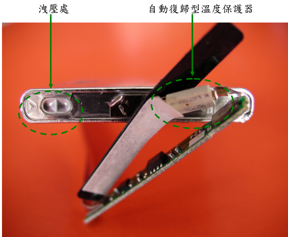
圖 3-4. 故障鋰二次電池內部
