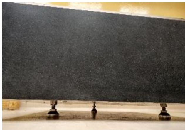
圖 1-3-12、花崗岩防震平台 3 點支撐圖
