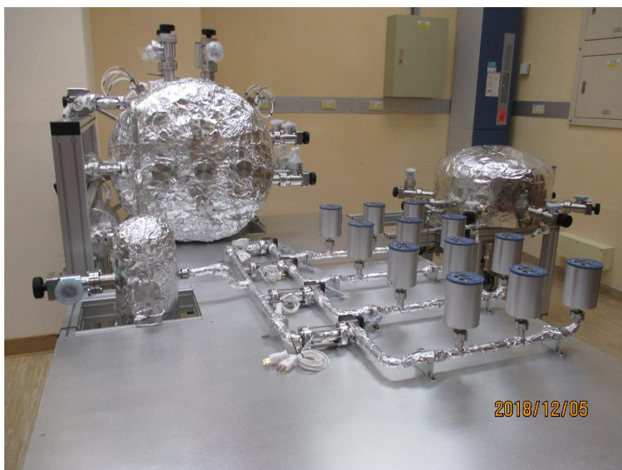
圖 5-1-9、靜態膨脹系統與直接比較式校正系統
