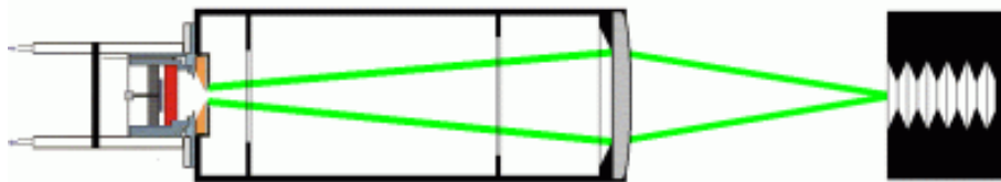
圖 5-2-5、ART 量測黑體的架構示意圖
