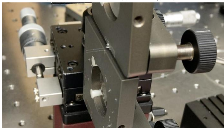
圖 3-1-7、VIPA + 光柵解析光梳的實驗裝置
