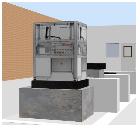
圖 5-1-3、全自動質量比較儀地下隔振設計示意圖
