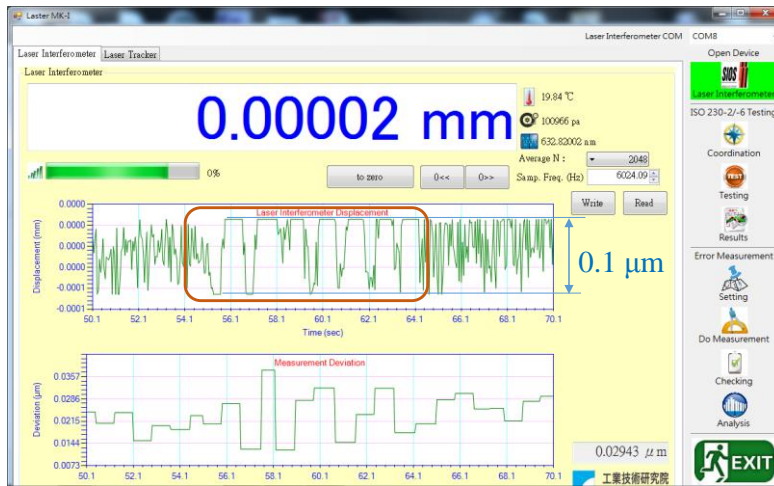
圖 2-1-4、測距解析測試，CMM 多步來回執行結果
