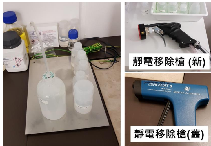
圖 5-4-4、樣品秤重區所使用樣品瓶與溶劑去除靜電設施設置現況(資料來源：德國 PTB)
