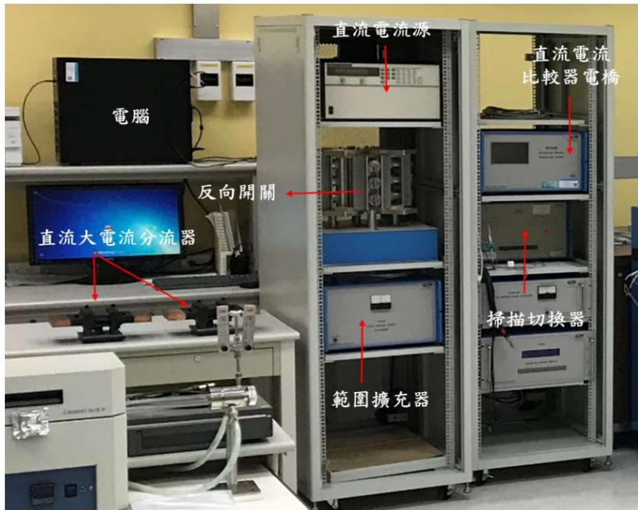
圖 6-31、低電阻電橋系統實體照片
