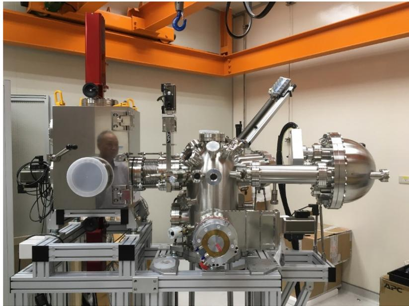
圖 6-3、整合式 XPS XRF 表層質量量測系統
