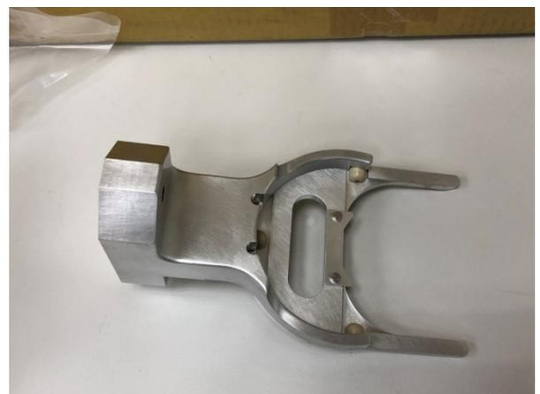
圖 6-12、標準片載台、夾爪及基座如設計圖
