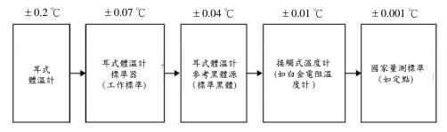
圖 4-3-4、耳式體溫計各階段溯源之不確定度需求
