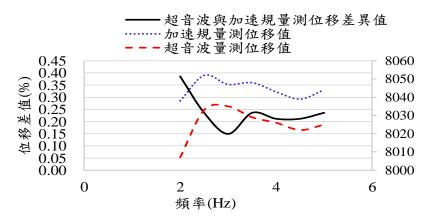
圖 2-1-17、頻率範圍(2~5) Hz 之超音波顫振檢測模組與加速規比對實驗結果 (位移差值=(超音波-加速規))
