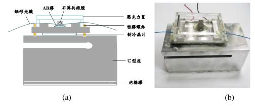
圖 3-1-6、(a)光梳台座側面示意圖;(b)光梳台座實體圖(未含覆蓋之絕熱泡棉)
