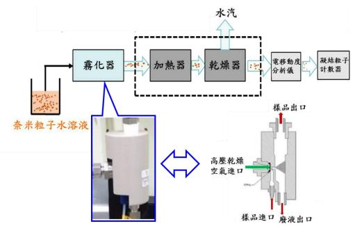
圖 2-3-1、氣霧化粒子粒徑及濃度量測系統架設示意圖
