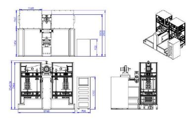
圖 2-4-1、扭矩標準量測系統設計圖
