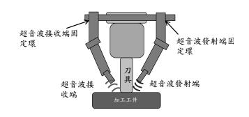
圖 2-1-15、工具機 In-situ 加工顫振檢測架構示意圖
