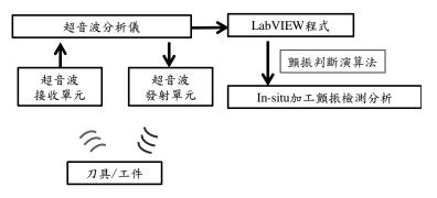
圖 2-1-14、工具機 In-situ 加工顫振檢測方法示意圖
