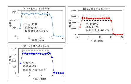
圖 2-3-11、分別以 Thermo 50 nm (左上)、100 nm (右上)與 300 nm (左下) 驗證膜組粒子濃度輸出結果圖
