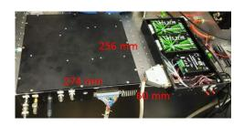
圖 2-1-6、小型化雙光梳的外觀,左邊為雷射頭、右邊為雷射驅動器
