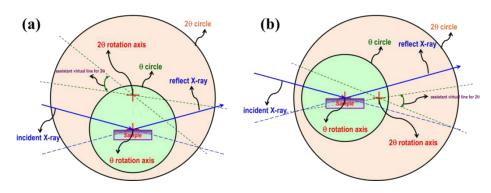
圖 3-3-2、樣品軸(θ)與偵測器軸(2θ)有(a)橫向與(b)縱向差異
