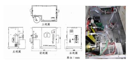
圖 2-3-9、標準粒子濃度產生模組設計圖(左)與內部配置(右)
