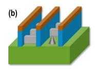
圖 3-3-1、(a) P 型金氧半矽鍺臨界尺寸量測;(b) 粒子導致缺陷
