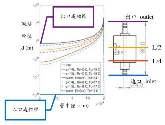
圖 2-3-5、10 nm 粒子於凝結器內凝結成長趨勢圖
