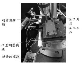
圖 2-1-20、顫振檢測模組與加工刀具工件
