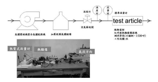
圖 3-4-2、硬體架構圖(氣體流量量測)
