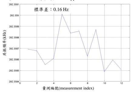
圖 3-2-6、質量感測懸臂樑共振頻率量測結果
