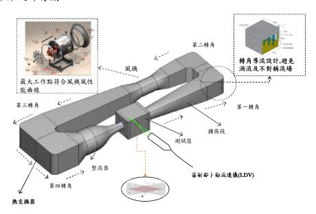
圖 1-3-23、風洞設計架構
