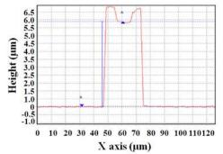
圖 2-2-8、UBM 量測形貌結果高度與直徑分析
