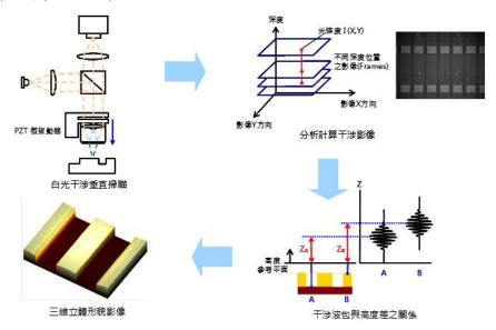
圖2-2-4、垂直掃描量測流程圖
