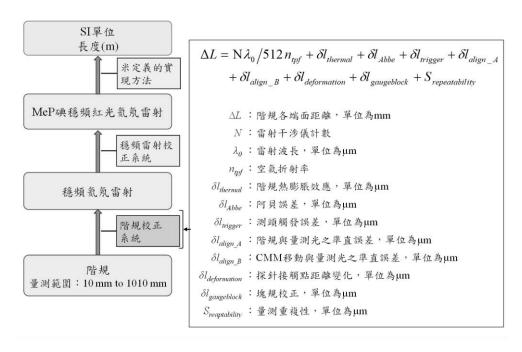
圖 2-1-1、階規校正系統追溯圖
