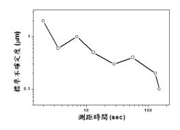
圖 2-1-9、桌上型雙光梳測距系統量測 1 m 之結果
