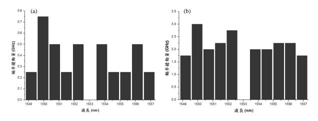
圖 3-1-15、以光譜儀於(a)10 與(b)60 分鐘內,分別擷取 11 次與 8 次的光譜圖,計算鄰近激發 波長(~1553 nm)之 10 根光梳的頻率最大擾動量長條圖
