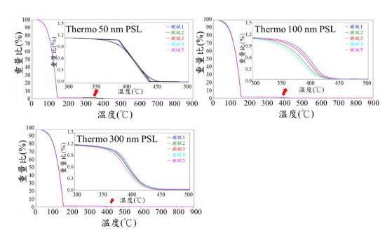
圖 2-3-10、TGA 測試 Thermo 50 nm、100 nm 及 300 nm PSL 溫度與樣品重量變化分析圖
