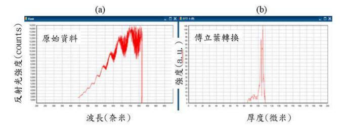
圖 2-2-14、PET 厚度量測原始資料
