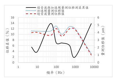
圖 2-1-188、頻率範圍(5~7000) Hz 之超音波顫振檢測模組與加速規比對實驗結果 (位移差值=(超音波-加速規))
