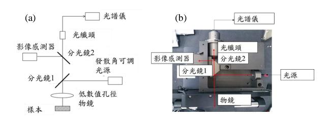
圖 2-2-9、(a)反射儀模組光路圖與(b)模組外觀
