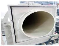
圖 1-3-25、循環式風洞設備測試區
