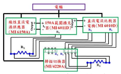
圖 1-3-14、直流電阻量測系統之硬體連接示意
