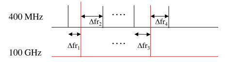
圖 3-1-9、100 GHz 微光梳與 400 MHz 之鎖模光纖雷射光梳拍頻示意圖
