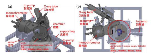
圖 3-3-3、長波長薄膜厚度與成份分析儀 3 維(a)總視圖和(b)總上視圖
