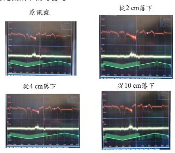
圖 3-1-7、光梳訊號撞擊測試圖
