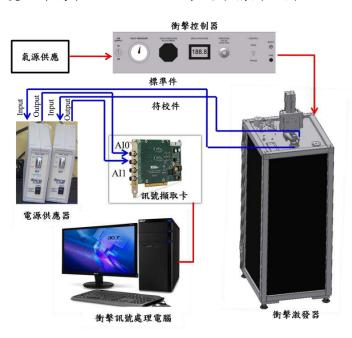
圖 1-3-12、衝擊振動比對校正系統
