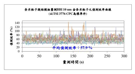
圖 2-3-8、奈米粒子凝結模組偵測效率測試圖
