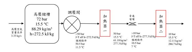
圖 1-3-20、高壓氣流溫控系統示意圖
