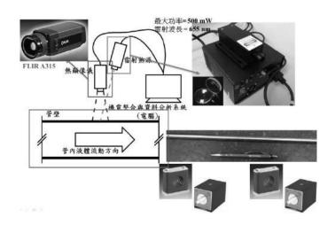
圖 3-4-3、熱顯像儀與脈衝雷射
