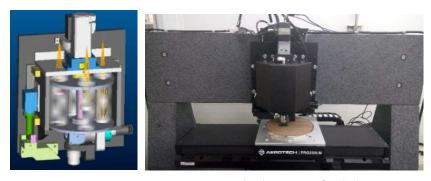
圖 2-2-3、白光干涉模組設計機構圖面與實體裝置圖
