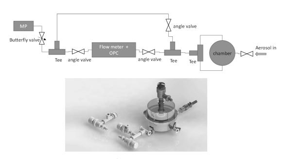
圖 3-2-4、真空及粒子取樣管路配置圖
