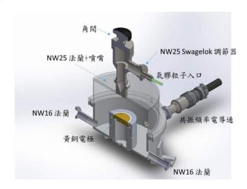
圖 3-2-3、空氣懸浮微粒質量量測系統架構圖
