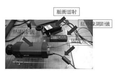
圖 3-4-4、熱顯像儀與脈衝雷射固定架
