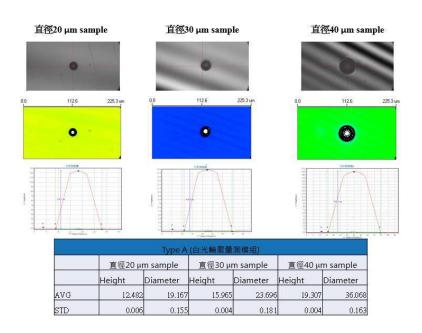
圖 2-2-7、半球型標準件量測測試結果
