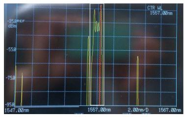
圖 3-1-10、濾波後 100 GHz 微光梳與 400 MHz 鎖模光纖雷射光梳耦合後之光譜圖
