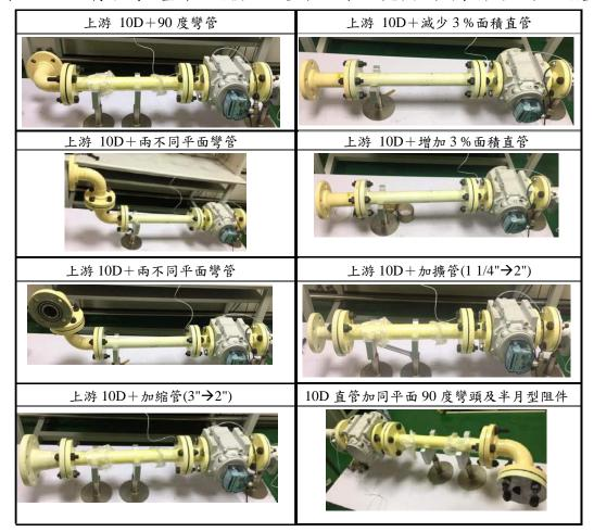
表 4-2-11、轉子式流量計先加 10D 直管後加上游不同安裝條件測試結果
