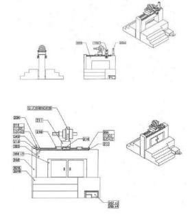
圖 2-4-2、基座總組合圖 (圖內代號是細部加工零件)
