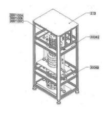
圖 2-4-5、法碼載荷機構組合圖(圖內代號是細部加工零件)
