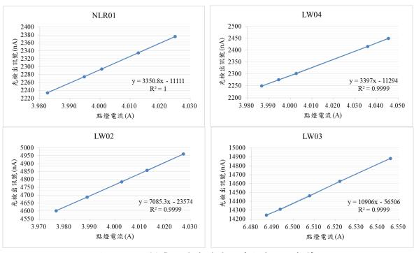
圖 1-3-10、標準燈電流變異不確定度評估數據
