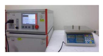
圖 4-1-2、B.3.1 交流電源電壓瞬降和短時中斷測試 EUT 配置
