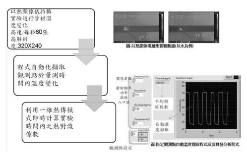
圖 3-4-5、自動化擷取流程及演算法分析程式
