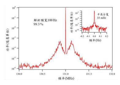
圖 2-1-7、穩頻後的偏差頻率,中心峰值線寬 3.3 mHz
