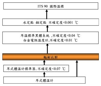
圖 4-3-3、耳式體溫計量測標準追溯圖
