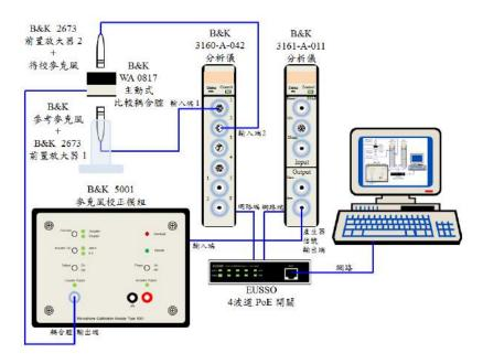
圖 1-3-18、麥克風比較式校正系統連線示意圖
