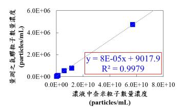
圖 2-3-4、氣霧化奈米粒子量測系統量測不同濃度 10 nm 奈米金粒子之檢量線
