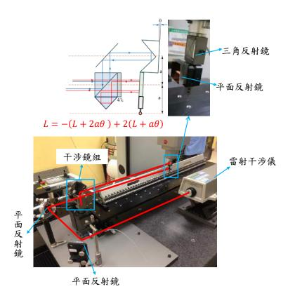
圖 2-1-2、階規校正系統架構
