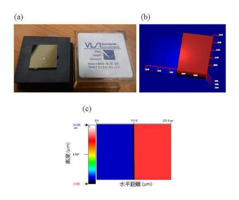
圖 2-2-6、標準階高量測結果:(a) VLSI 標準塊;(b) 三維形貌量測結果; (c) 量測結果上視圖
