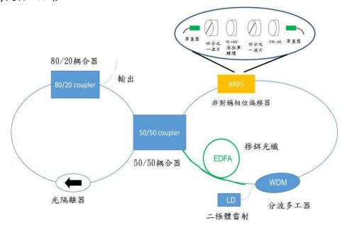
圖 2-1-8、全保偏光纖 8 字型鎖模光纖雷射架構圖
