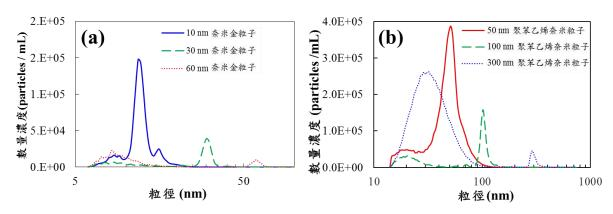
圖 2-3-2、霧化器模組搭配 DMAS 量測不同粒徑奈米粒子之粒徑與數量濃度分布圖
