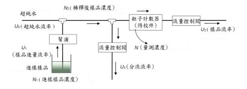
圖 2-3-12、粒子濃度輸出模組工作示意圖
