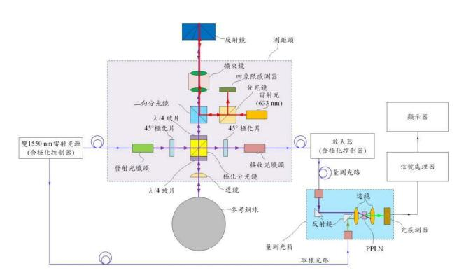
圖 2-1-12、雙光梳絕對測距與兩軸旋轉治具整合架構圖
