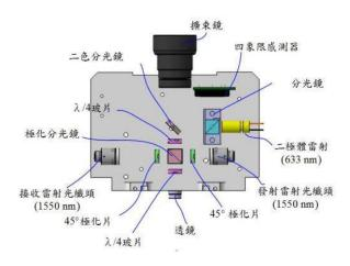
圖 2-1-13、雙光梳絕對測距之測距頭設計圖
