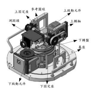
圖 2-1-11、雙光梳絕對測距與兩軸旋轉治具整合機構設計圖
