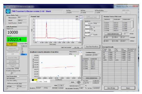
圖 1-3-13、比較式衝擊校正系統衝擊完成圖
