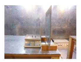
圖 4-1-9、靜電試驗(間接放電)與 EUT 配置圖
