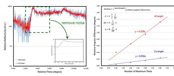
圖 3-3-9、長波長薄膜 X 光反射光譜量測
