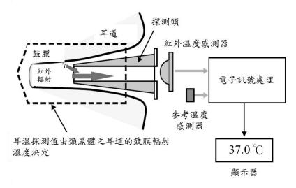
圖 4-3-2、耳溫量測原理
