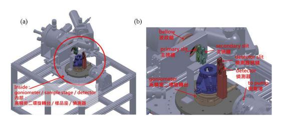
圖 3-3-4、長波長薄膜厚度與成份分析儀三維總視圖內部(a)概略視圖與(b)細視圖
