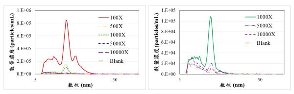
圖 2-3-3、霧化器模組搭配 DMAS 量測不同濃度 BBI 10 nm 奈米金粒子之粒徑與 數量濃度分布圖
