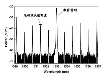
圖 3-1-14、高密度分波多工用光梳光譜圖與頻率擾動量示意圖
