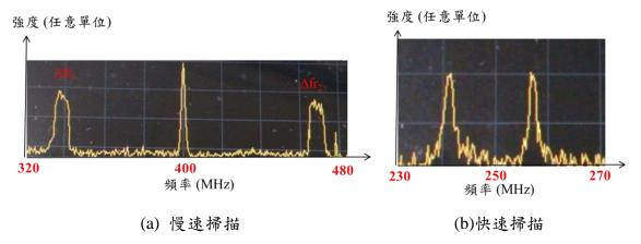
圖 3-1-12、6 個自由光譜範圍主微光梳之 1 根光梳與 400 MHz 之鎖模光纖雷射光梳 拍頻後掃描頻譜圖
