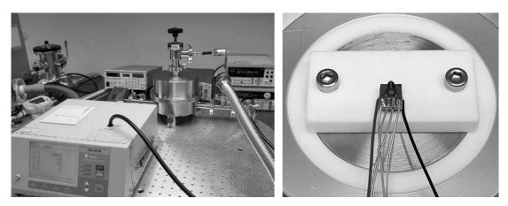
圖 3-2-5、系統與質量感測懸臂樑模組實體照片
