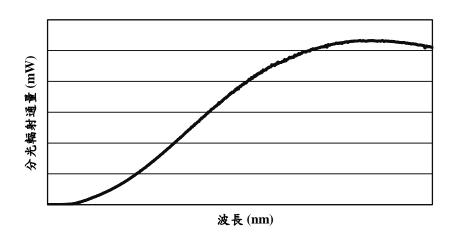
圖 1-3-9、陣列式光譜儀校正後之光譜量測結果(分光輻射通量)
