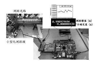
圖 2-1-10、小型化雙光梳絕對測距頭與擷取分析模組圖,右上角為測距結果
