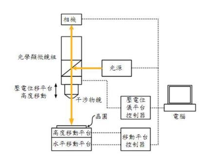
圖2-2-2、白光干涉三維檢測系統示意圖
