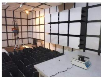
圖 4-1-12、電磁耐受性測試項目之架設配置圖
