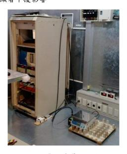
圖 4-1-14、射頻場感應傳導擾動與 EUT 配置圖
