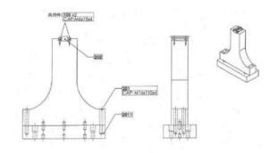
圖 2-4-3、天平刀座組合(圖內代號是細部加工零件)
