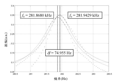
圖 3-2-9、質量感測懸臂樑共振頻率量測結果
