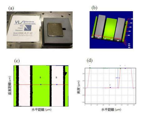
圖2-2-5、標準線寬量測結果:(a) VLSI 標準塊;(b) 三維形貌量測結果; (c) 量測結果上視圖;(d) 量測結果剖線資訊
