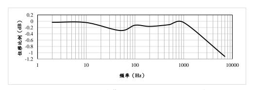
圖 2-1-199、顫振檢測模組頻域響應圖(位移比例=20log(超音波/加速規))
