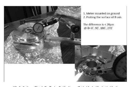
圖 3-3-8、實測高真空高精密二環旋轉台樣品旋轉面
