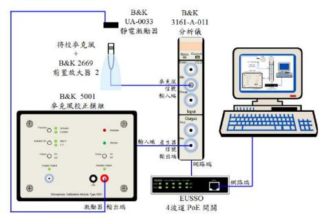
圖 1-3-19、麥克風頻率響應量測系統連線示意圖
