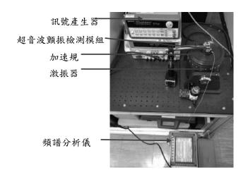
圖 2-1-16、超音波顫振檢測模組與加速規比對實驗架構
