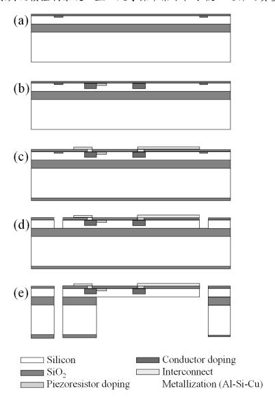
圖 3-2-1、質量感測懸臂樑主要製作流程
