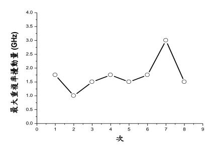
圖 3-1-16、以光譜儀於 60 分鐘內, 擷取 8 次的光譜圖, 計算鄰近激發波長(~ 1553 nm) 之 10 根光梳的重複率最大擾動量曲線圖
