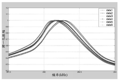
圖 3-2-10、固定質量連續沉積所測得之共振頻率量測頻譜
