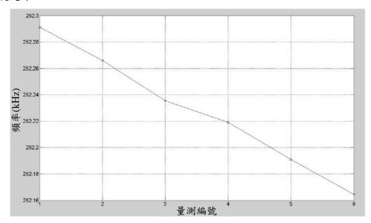
圖 3-2-11、固定質量連續沉積所測得之共振頻率漂移
