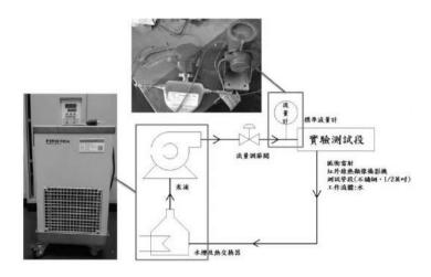
圖 3-4-1、硬體架構圖(液體流量量測)
