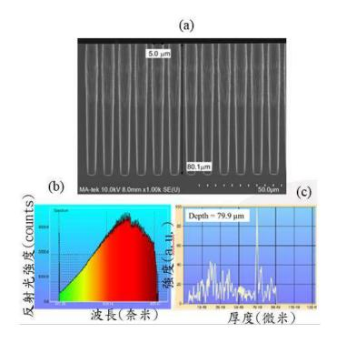
圖 2-2-12、(a)TSV 電子掃描顯微鏡切片量測影像 (b)TSV 深度量測原始光譜資料 (b)傅立葉轉換結果
