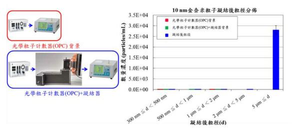
圖 2-3-7、奈米粒子凝結模組性能測試圖
