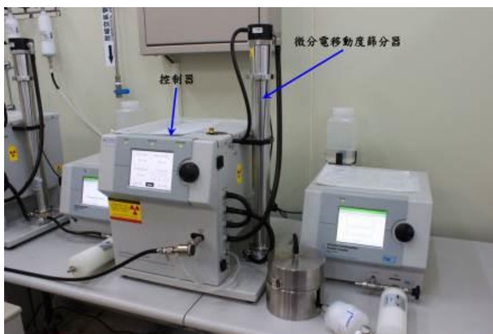
圖 3-2-8、微分電移動度篩分器
