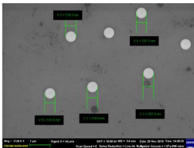
(c) 粒子沉積後 cantilever 表面(圖(b)圈選處)局部放大
