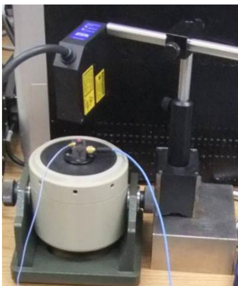
圖 2-1-29、加速規與雷射位移感測器比對現場量測照片
