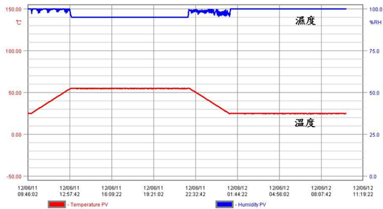
圖 4-1-2、試驗箱自動化後實測結果
