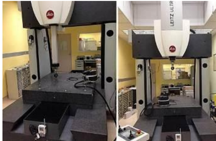
圖 2-1-3、LaserTRACER 實際進行 CMM 校正之情況
