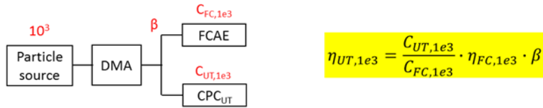
圖 3-1-5、待校件在 1000 \text{ cm}^{-3} 之濃度下之偵測效率評估
