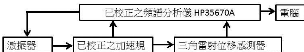
圖 2-1-30、加速規與雷射位移感測器比對實驗架構示意圖
