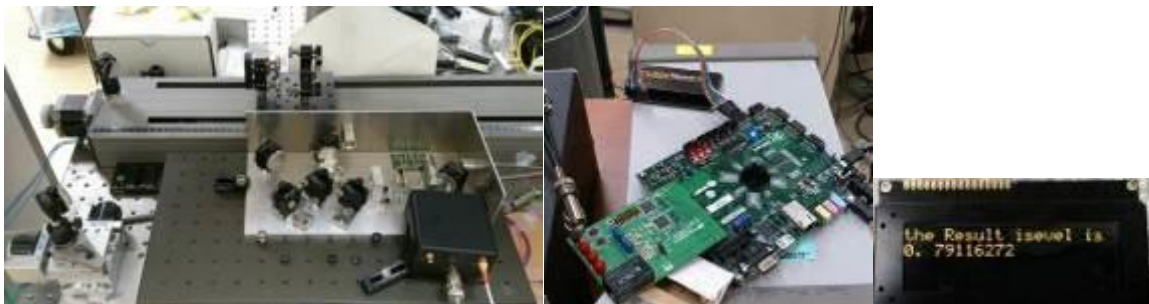
圖 2-1-22、左為小型化雷射絕對測距測頭實體照片，中為 FPGA 絕對測距信號處理電路板，右為絕對測距位移 OLED 顯示器
