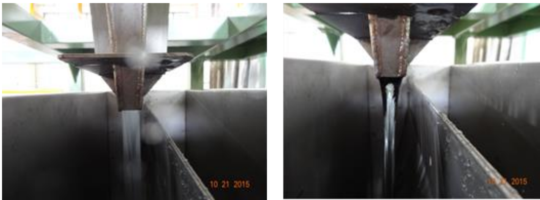
圖 1-4-5、F02 系統雙通道矩形導流噴嘴管於最高流和最低流實際流態圖
