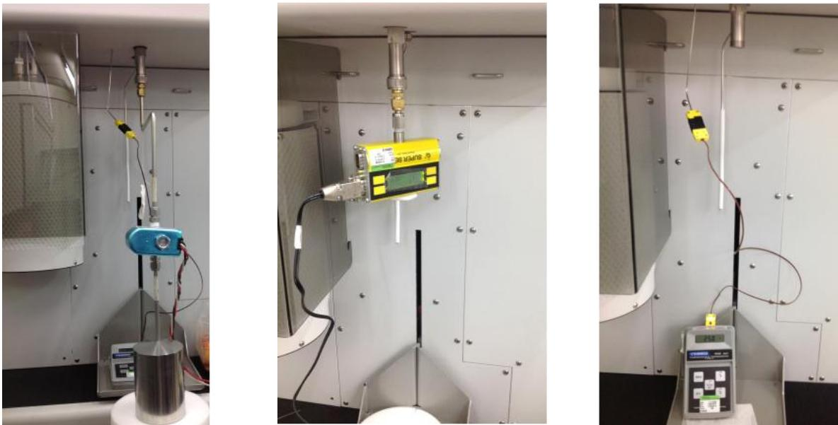
圖 1-2-10 儀器校正架設，由左到右分別為標準體積、壓力計與溫度計
