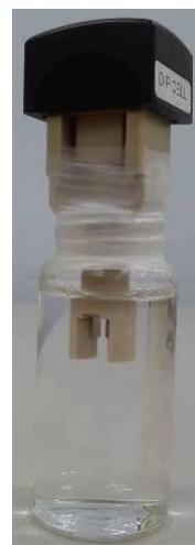
圖 1-3-3：使用超音波震盪清潔電極之架設
