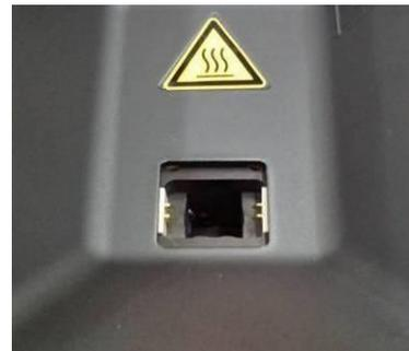
圖 1-3-7：樣品量測室之電極接觸點
