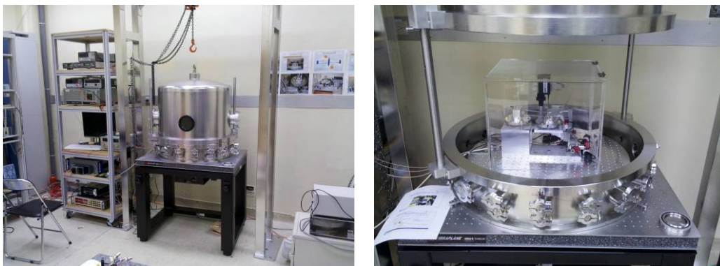
圖 1-26 靜電式偵測與致動微力量測系統
