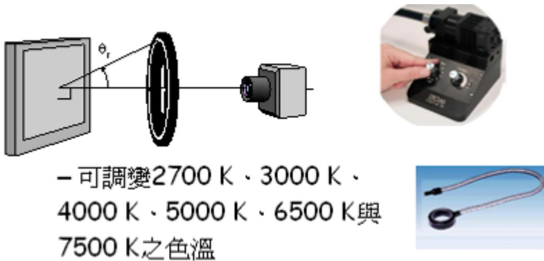
圖 10 光源儀控設備與 ring light-guide
