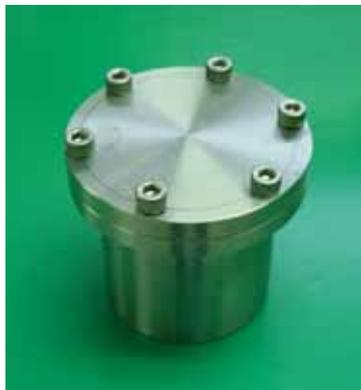
圖一：Autoclave 組裝完成圖
